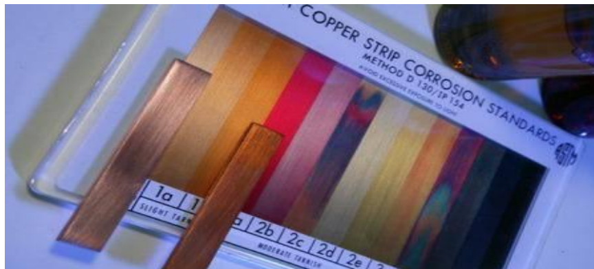
Figura 3. Guía para la evaluación del grado de corrosión en la tira de cobre
