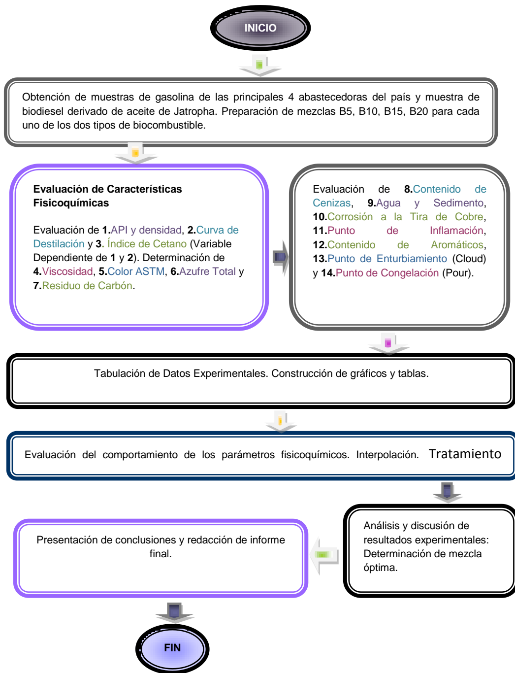
Figura 5. Diagrama de flujo de evaluación de muestras de diésel-biodiesel
