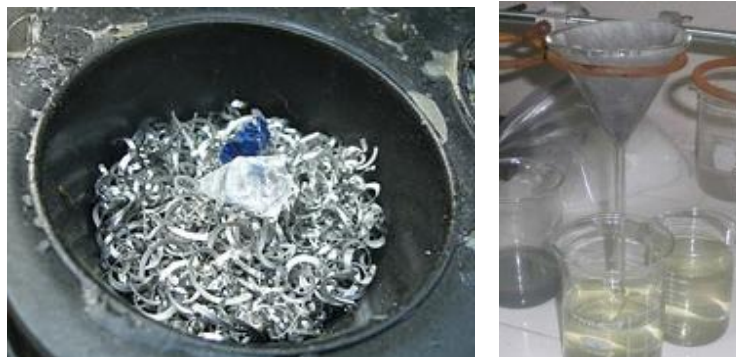
Figura 44. Etapa de remoción de iones Hg (II) por adición de Zn
