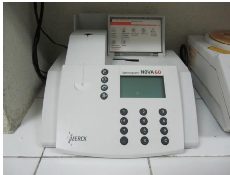
Figura 27. Espectrofotómetro de UV – visible, utilizado para la medición de los metales pesados
