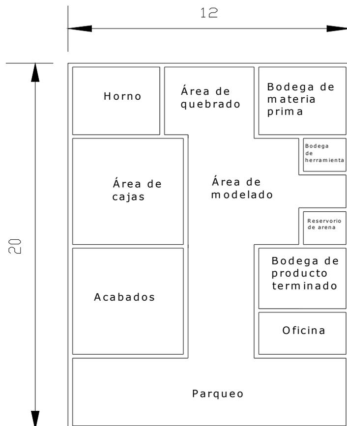
**Figura 36. Redistribución de la planta y acomodamiento de la infraestructura física**
