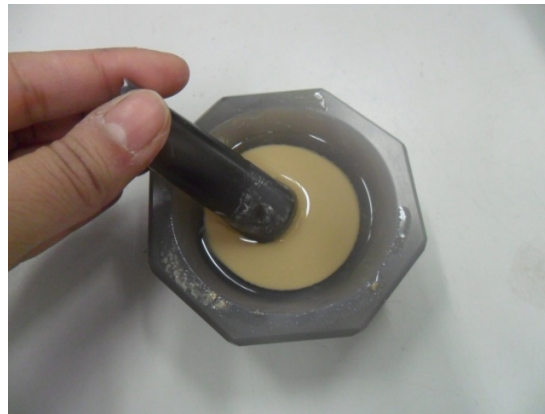
Figura 29. Lavado con acetona de la muestra molida
