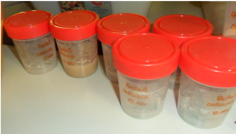
Figura 26. Curado de las pastas en recipientes plásticos herméticos
