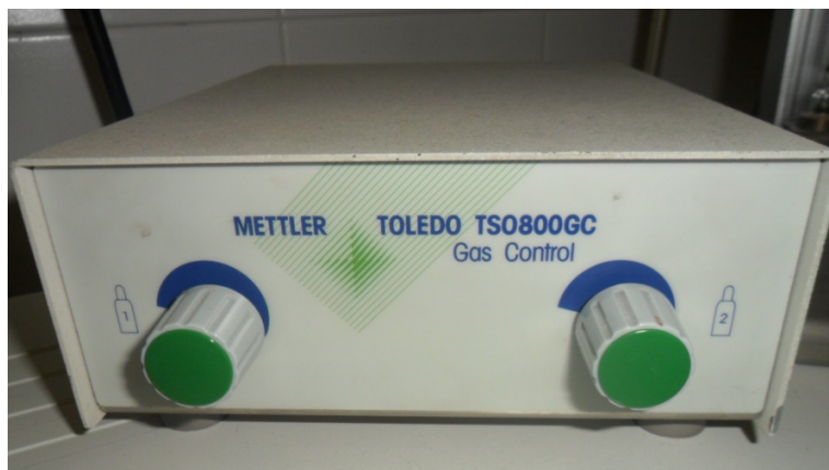
Figura 36. Controlador de gas del analizador termogravimétrico
