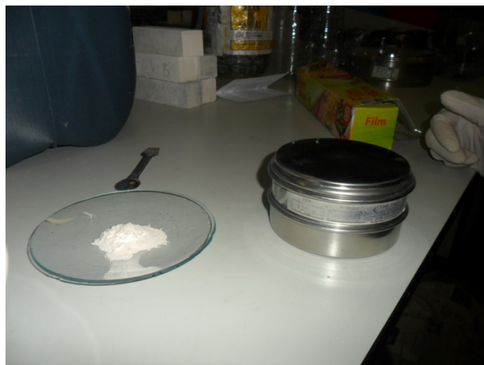
Figura 19. Fotografía de tamiz de 125 \mu m
