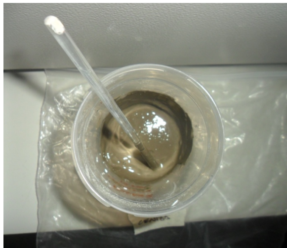
Figura 25. Homogenización de la pasta en húmedo
