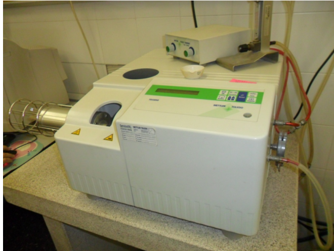
Figura 14. Fotografía del analizador termogravimétrico utilizado
