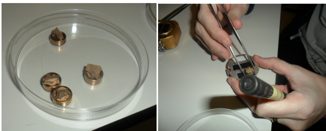
Figura 39. Muestras recubiertas de oro
