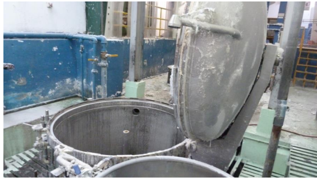
Figura 4. Autoclave donde se lleva a cabo el lavado del algodón
