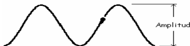
Figura 10. Onda de vibración armónica indicando amplitud pico a pico
