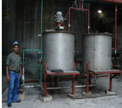
Figura 22. Dosificador de donador de SO 2 a la balanza de jugo mixto
