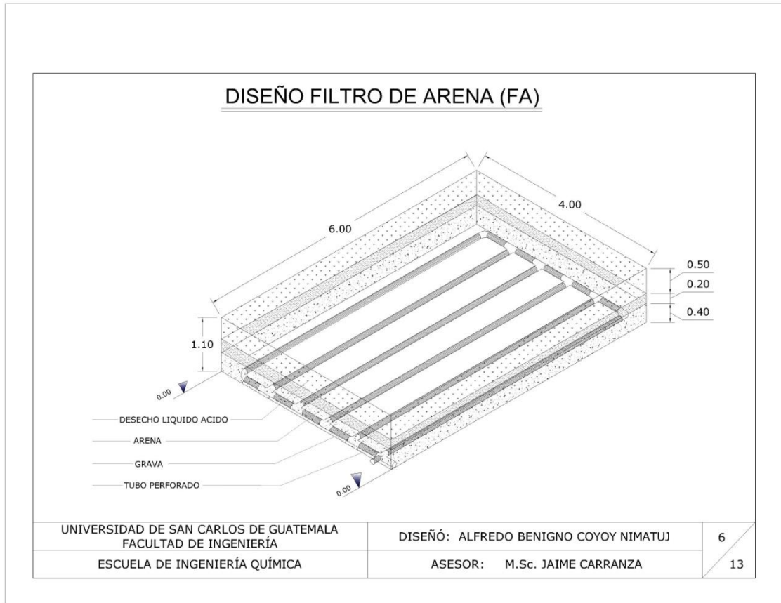
Figura 10. Diseño filtro de arena (FA)
