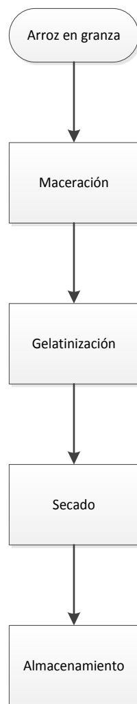
Figura 4. Proceso de precocción de arroz
