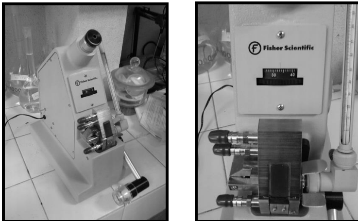
Figura 22. Refractómetro Abbe utilizado en el experimento
