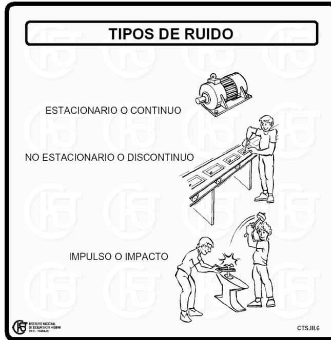
En la planta de fabricación de muebles se estarán emitiendo prácticamente los tres tipos arriba descritos. La emisión de sonido producido por el funcionamiento de los motores de la maquinaria dará origen al ruido estacionario o continuo.
