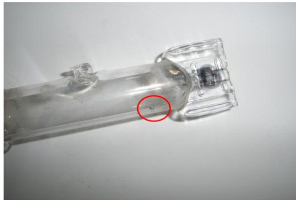
Figura 4 Gota de mercurio elemental en ampolla de cuarzo
