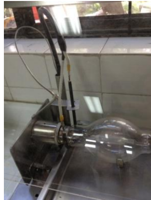
Figura 12 Colocación de Bombilla en Equipo de Corte Diseñado por el Equipo de Investigación
