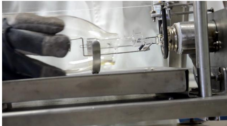
Figura 8 Detalle de los componentes de las lámparas de vapor de mercurio ya cortada por la unidad diseñada en el proyecto FODECYT 19-2010
