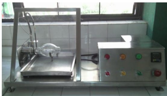
Figura 7 Unidad diseñada por el proyecto FODECYT 19-2010 para el corte de bombillos de luminarias de alumbrado público
