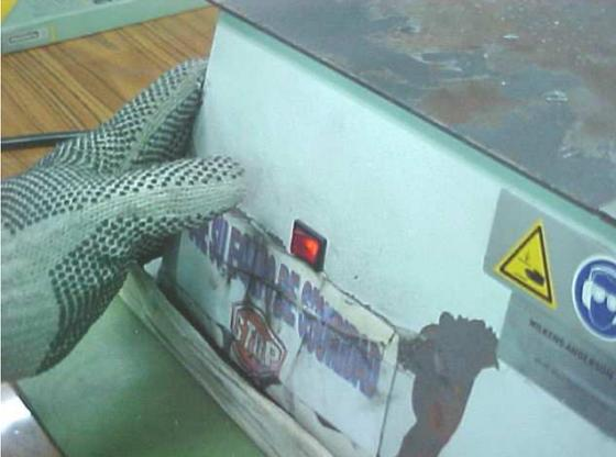
2. Poner el envase horizontalmente sobre la plataforma del equipo, con la parte de corte de cara a la doble sierra.
