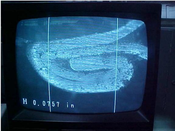
5. Mover el cursor derecho en la pantalla a la posición deseada, girando convenientemente el botón derecho del panel frontal.
