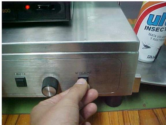
9. Utilizar los botones del panel frontal para mover convenientemente el cursor de arriba y el cursor de abajo a las posiciones deseadas para tomar una medida.
