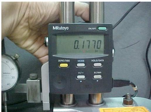
6. Bajar el deslizador hasta que el tornillo medidor coincida con el punto donde se desea tomar la medida y la aguja en el dial marque "0".
