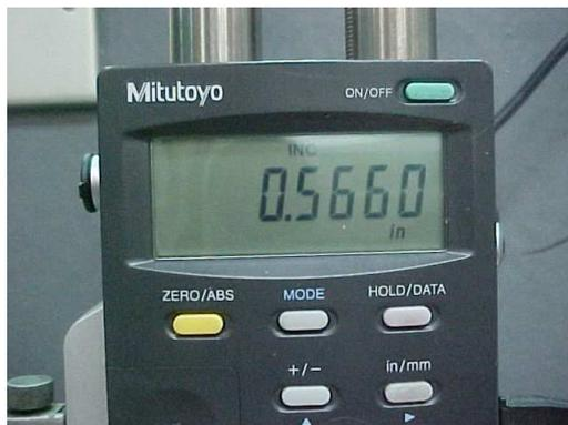
9. Presionar tecla HOLD/DATA si se desea guarda la lectura en una base de datos.
