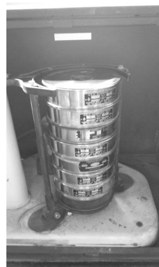
Figura 18. Equipo donde se realizó el tamizado
