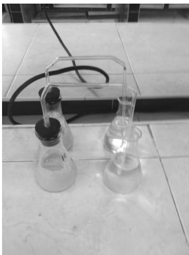
Figura 30. Sistema de fermentación
