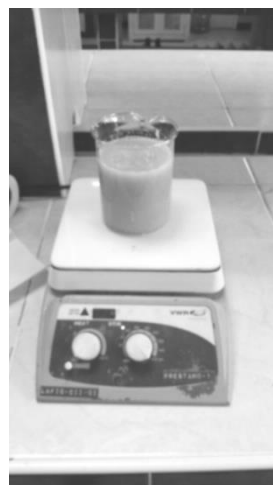
Figura 20. Ataque con hidróxido de sodio
