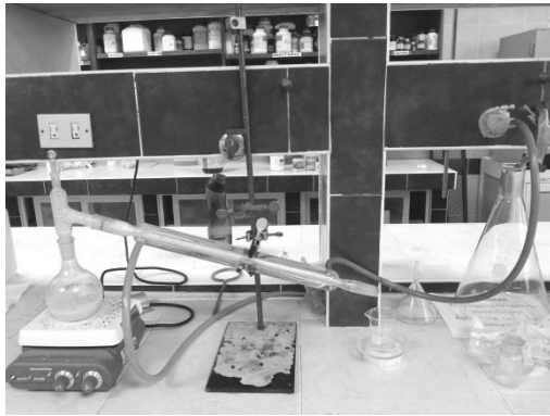
Figura 32. Sistema de destilación
