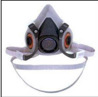
Mascarilla tipo II: cubre media cara del operador posee dos espacios a los lados para colocar los filtros desechables, ya sea químicos o para polvo. La máscara está fabricada en caucho antialérgico. Debe tener dos válvulas de inhalación y una de exhalación
