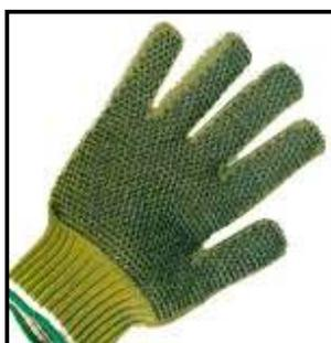
Tipo I: deben ser utilizados por los operadores que alimentan manualmente la máquina y por aquellos que entariman el producto procesado, también los deben usar el personal que maneja las cuchillas de corte en las diferentes máquinas que las poseen. Este tipo de guante posee un recubrimiento en la parte interna de la mano hecha de polipropileno que le confiere protección, flexibilidad y antideslizamiento para realizar las tareas sin ningún impedimento.
