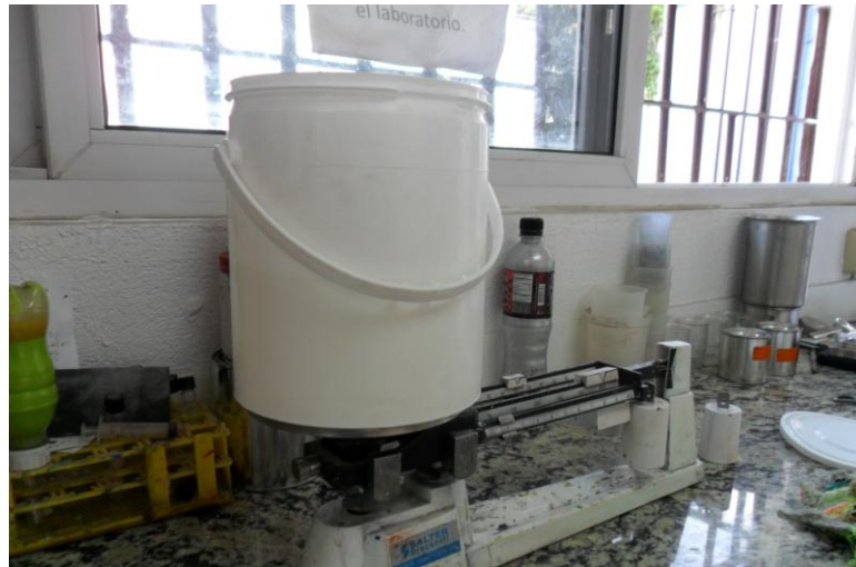
Figura 7. Fotografía de forma en que se pesa la materia prima para hacer un galón de cada base
