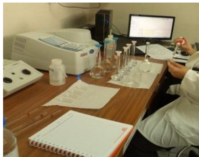
Figura 22. Fotografías del procedimiento para la determinación de sílice disuelta y reducción de alcalinidad
