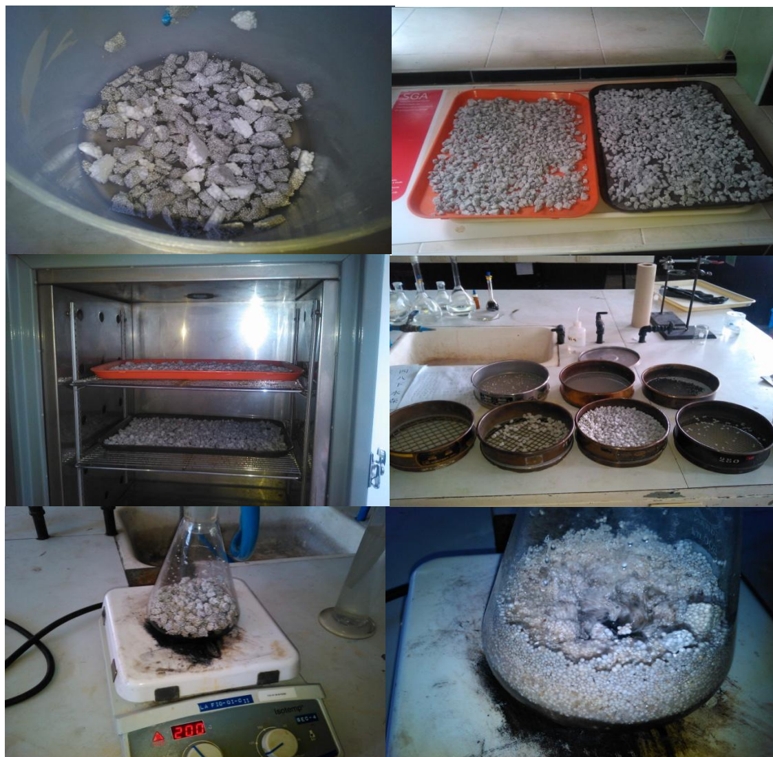
Figura 57. Procedimiento de elaboración de la resina de intercambio catiónico a partir de poliestireno reciclado
