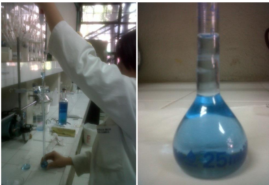
Figura 28. Llenado del matraz de Le Châtelier con un volumen definido de kerosene
