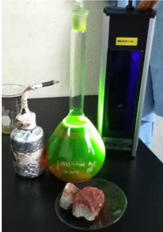
Figura 32. Método de fluorescencia, para evidencia visual de las fisuras en el agregado grueso
