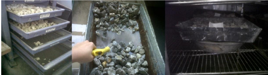
Figura 9. Preparación del agregado grueso para prueba, granulometría, lavado y secado
