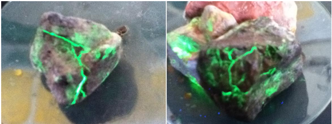
Figura 42. Detalle de las fracturas generadas en el proceso de secado del agregado grueso y resaltadas mediante el uso del indicador de contraste, fluoresceína sódica y observada mediante iluminación con luz ultravioleta
