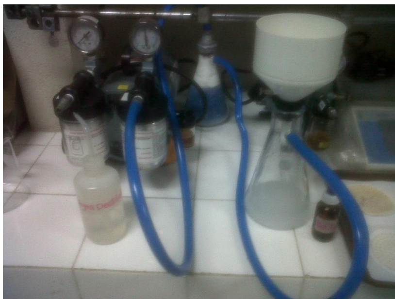
Figura 24. Sistema de filtrado al vacío para eliminar del papel filtro los cristales de sulfato de sodio formados en cada uno de los ciclos de filtrado
