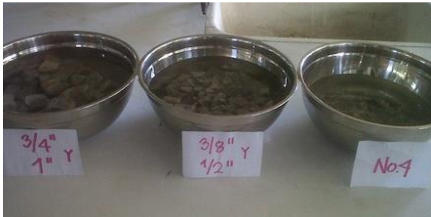
Figura 12. Proceso de imbibición de la solución de sulfato de sodio en el agregado grueso
