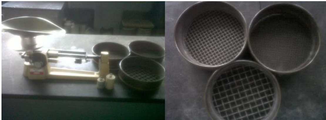
Figura 16. Equipo para examen cuantitativo de granulometría final del agregado, inciso 9 ASTM C 88-99a
