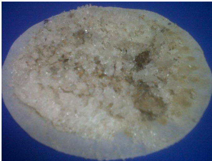
Figura 23. Papel filtro húmedo con cristales de sulfato de sodio decahidratado y partículas de agregado y arcilla
