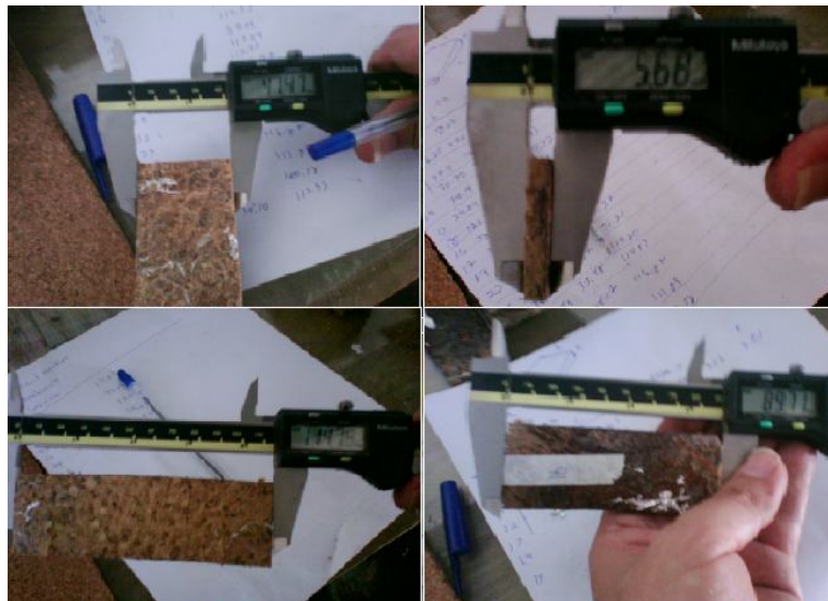
Figura 31. Medición de las piezas de madera plastica a ensayar
