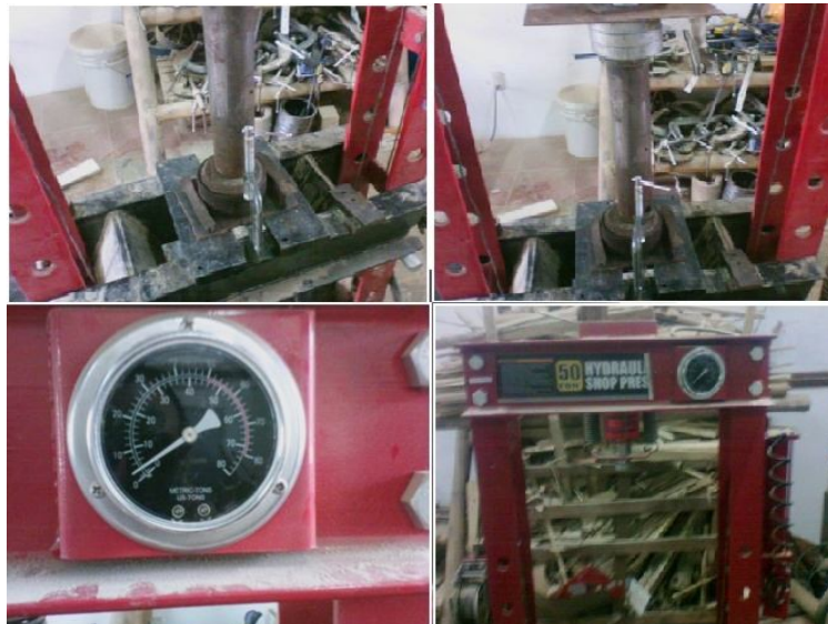
Figura 29. Compresión de las piezas de madera plástica
