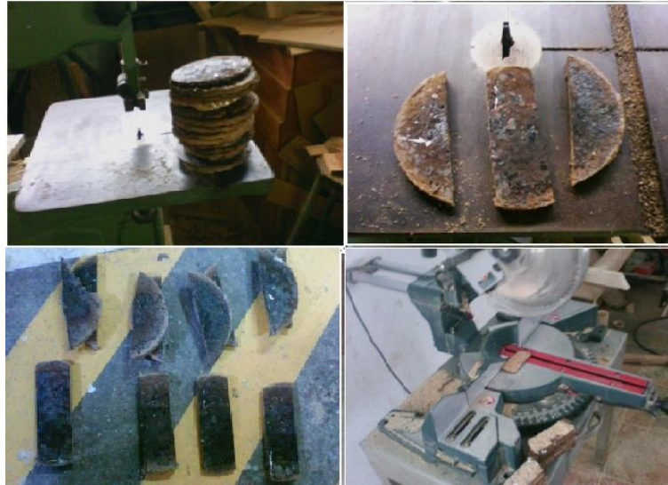
Figura 30. Cortado de las piezas de madera plastic
