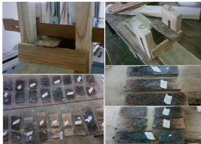
Figura 33. Prueba de flexión estática
