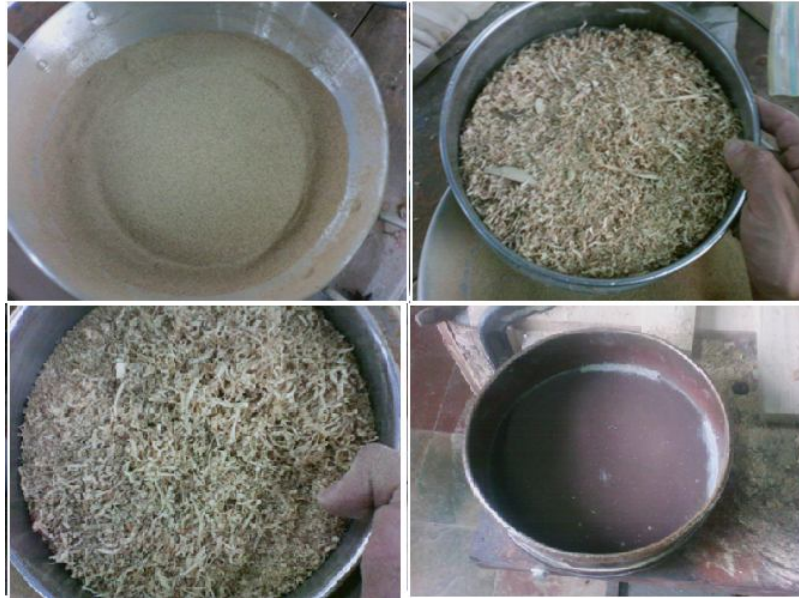
Figura 26. Tamizado del aserrín
