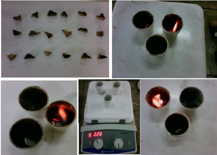
Figura 34. Prueba de la temperatura de inflamación
