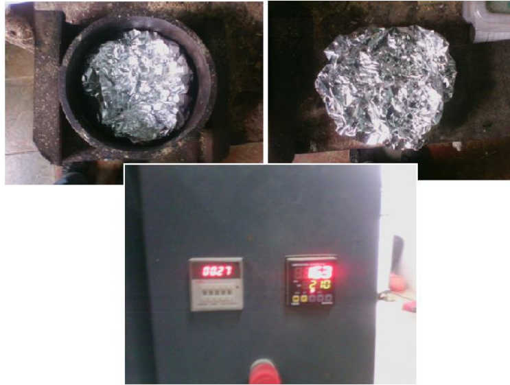
Figura 28. Horneado de las piezas de madera plástica
