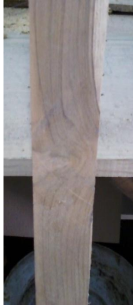
Figura 8. Probeta de madera teca ( Tectona grandis ), se aprecia las vetas no alineadas
