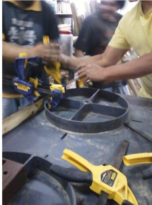
Figura 7. Probetas en el proceso de curvado después de sacarlas de la cámara de vaporizado
