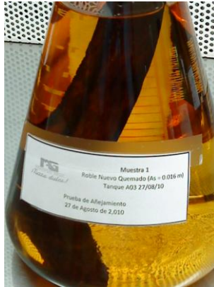
Figura 12. Alcohol etílico con trozo de roble blanco nuevo y quemado
