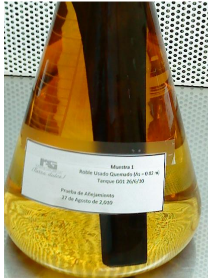
Figura 10. Alcohol etílico con trozo de roble blanco usado y quemado
