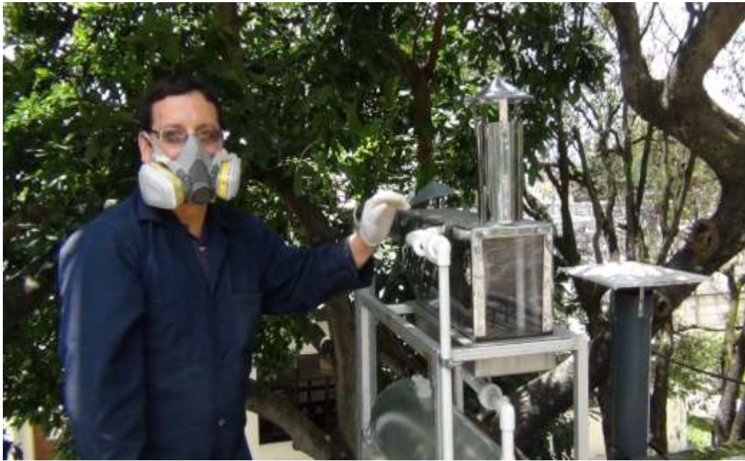
Figura 19. Monitoreo en el lavador de gases
