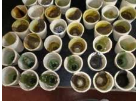
Figura 21. Residuos del análisis de oro por ensayo al fuego
