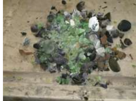
Figura 21. Residuos del análisis de oro por ensayo al fuego
