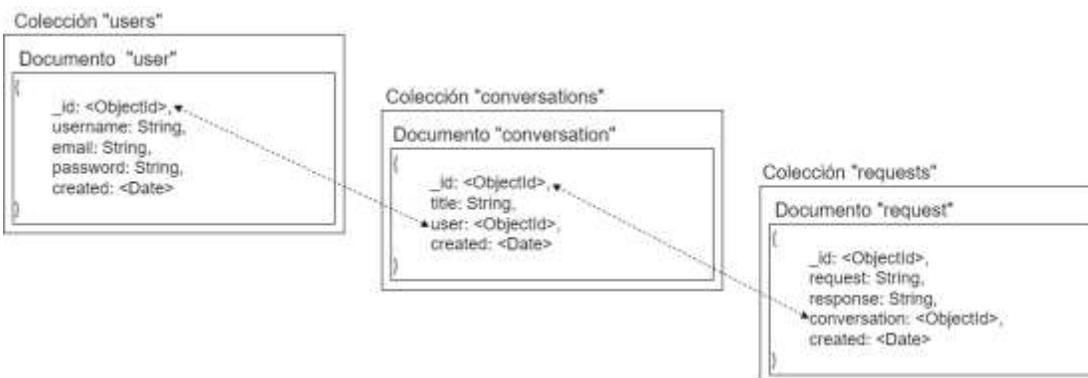
*Nota.* El gráfico muestra el modelo de datos que utilizará el sistema. Elaboración propia, realizado con draw.io.
