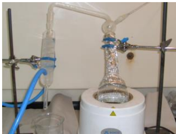
Figura 1. Equipo de destilación, LIEXVE
