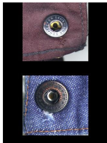
Figura 24. Defectos por accesorios
