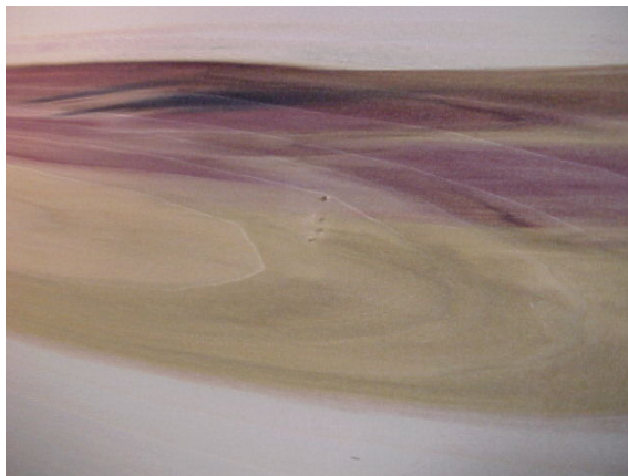
Figura 12. Manchas superficiales de la madera
