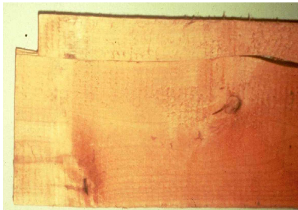
Figura 20. Tensiones de crecimiento
