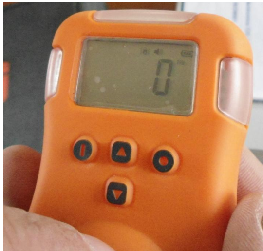
Figura 18. Concentración de sulfuro de hidrógeno en ppm a la salida del desulfurizador
