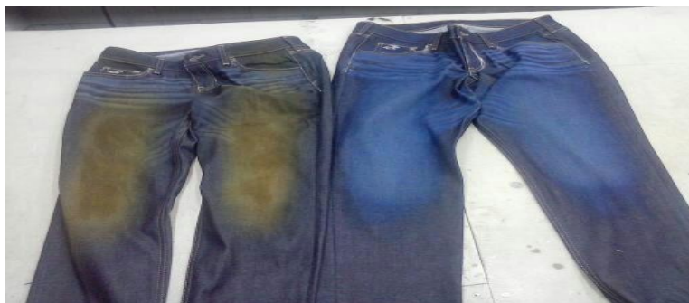
Figura 5. Pantalón con permanganato de potasio del lado izquierdo y pantalón neutralizado terminado del lado derecho
