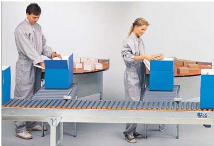
Diseño de transportadores con rodillos motorizados para una línea de producción continua, se utiliza mucho en farmacéuticas, es fiable y silencioso
