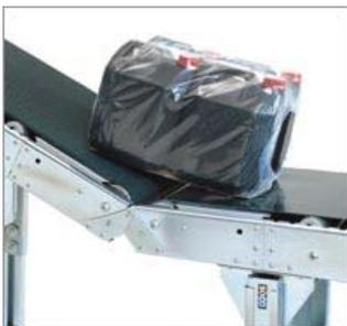
Los transportadores con alimentadores se utilizan para el transporte de productos inestables, ya que el ángulo de transferencia es suave, figura 11
