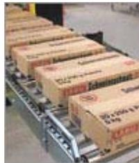
Ejemplos de módulos: Transportadores de rodillos, de roldanas, extensibles, motorizados, curvas extensible, curvas fijas, transportadores de banda, indexadores, elevadores verticales, mesas rotativas, sistemas de pesaje, empujadores, etc. El sistema de transportadores se suministra electrogalvanizado, en acero inoxidable o como el cliente desee, pero en la propuesta se utilizará de acero inoxidable.
