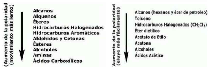
Figura 5. Orden de elusión de compuestos y polaridad
