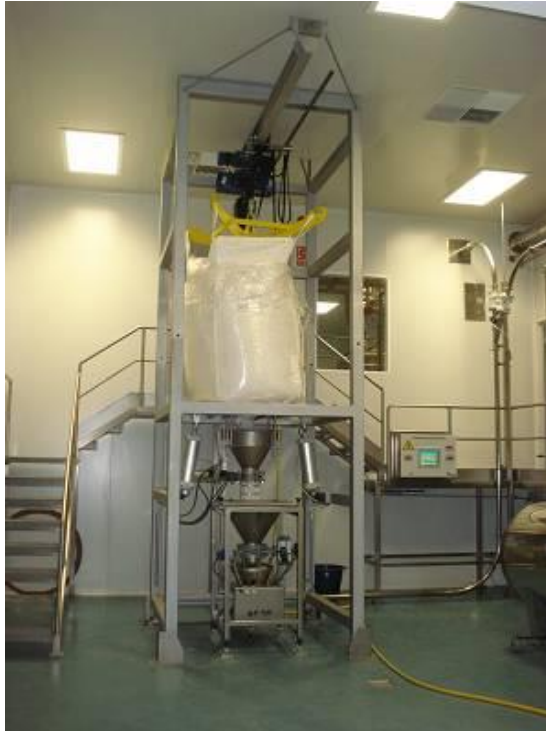
Figura 4. Sistema de envasado de big bag
