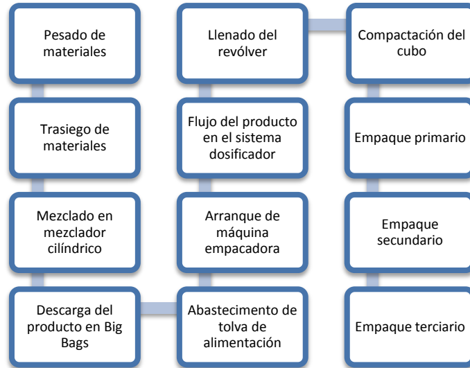
Figura 5. Proceso de elaboración del caldo de pollo en cubito
