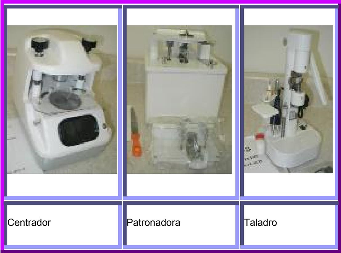
Figura 27 Equipo auxiliar para talla de lentes
