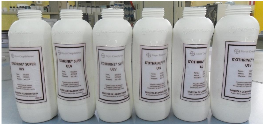
Figura. 4.4. Migración del insecticida hacia afuera del envase, la etiqueta decolorada muestra la migración
