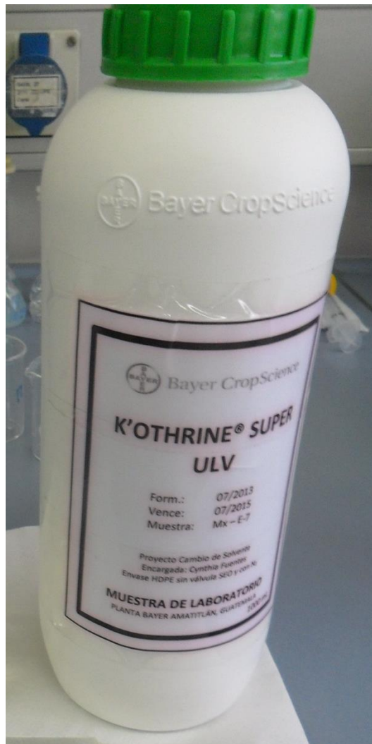
Figura. 4.5. Migración del insecticida hacia afuera del envase, la etiqueta decolorada muestra la migración
