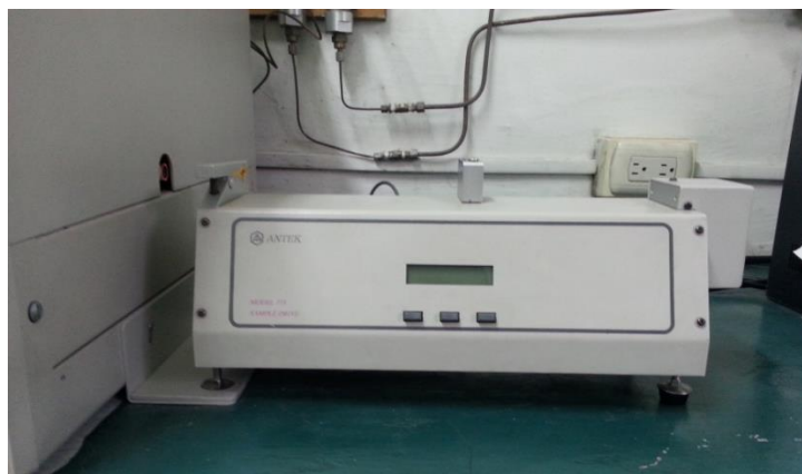
Apéndice 19. Inyector modelo 735 para el analizador de azufre Antek Serie 9000
