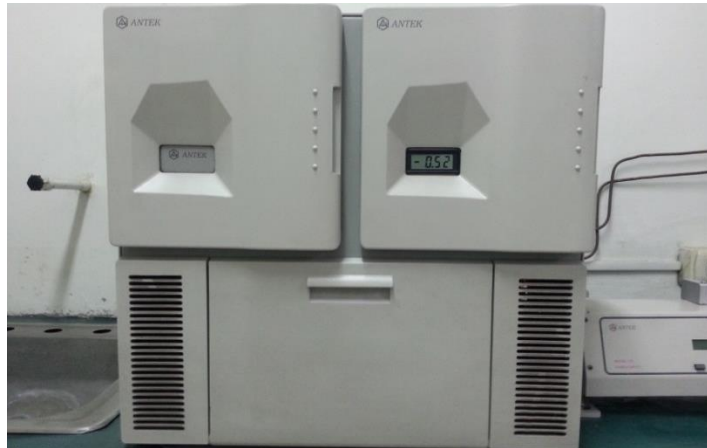
Apéndice 18. Parte frontal del analizador de azufre Antek Serie 9000
