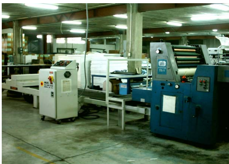
Figura 14. Máquina para recubrimiento barniz UV
