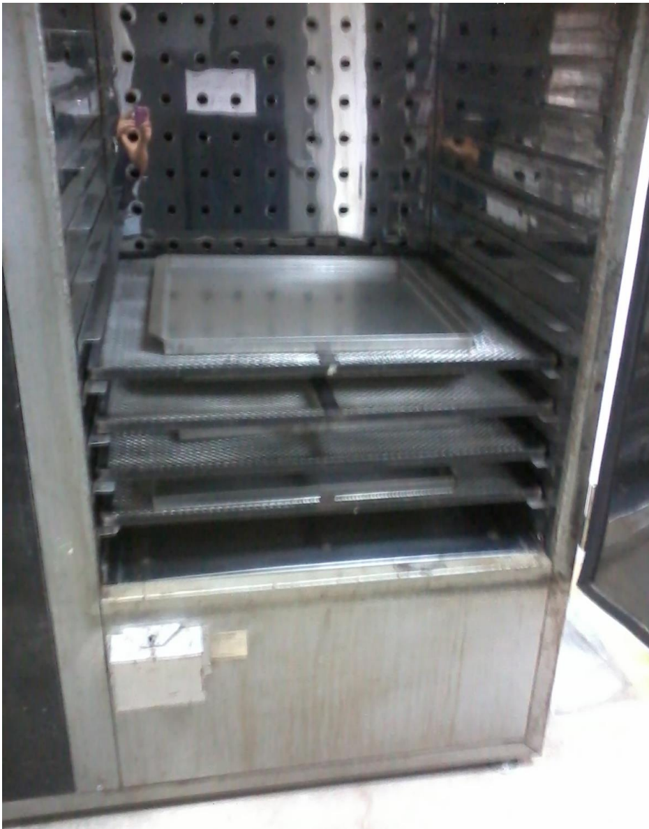
Ilustración 4. Secador eléctrico de bandejas de flujo transversal de 1200 Watt
