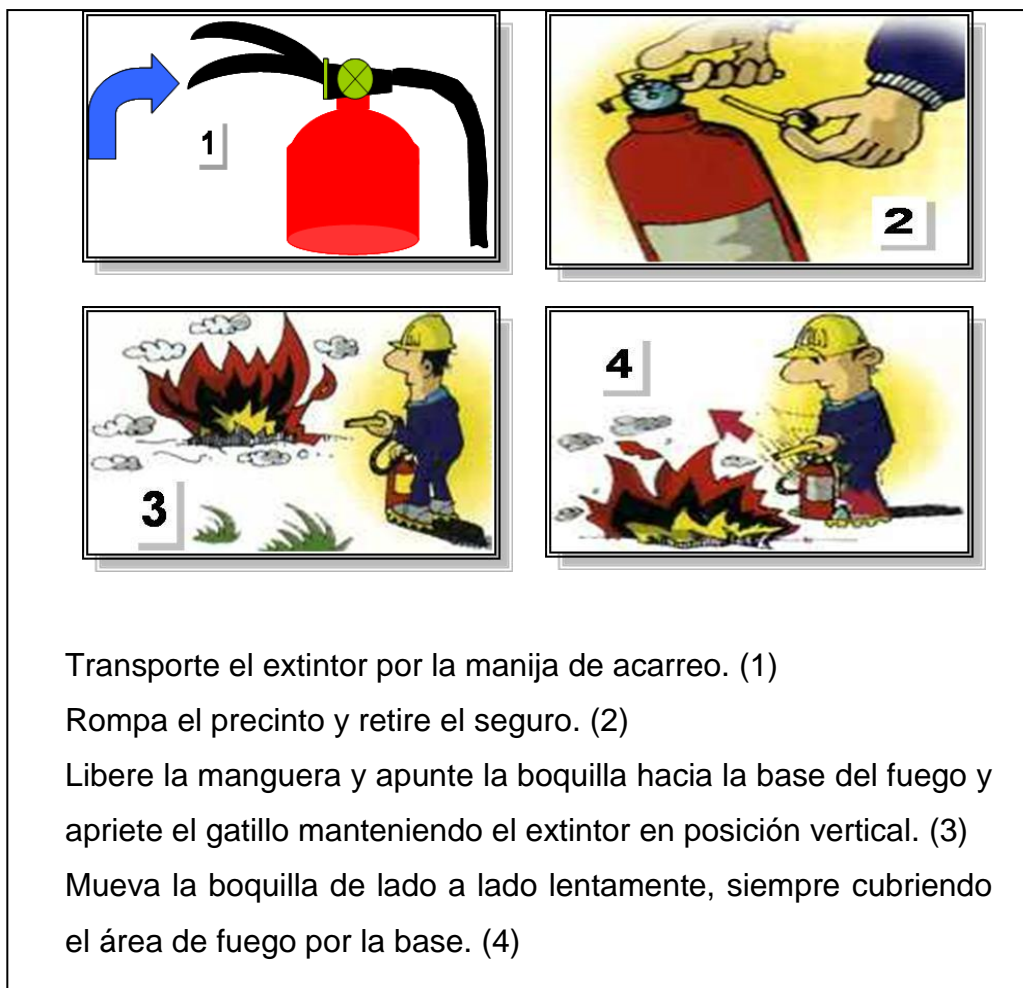
Figura 3. Uso de extintor
