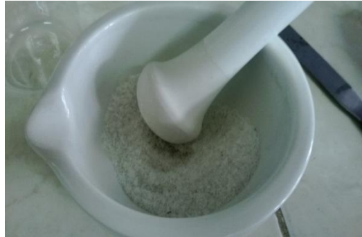
Figura 12. Mezcla del PET con NaCl
