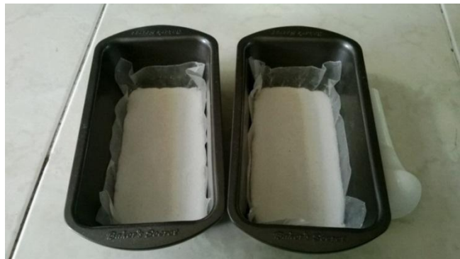
Figura 13. Resina compactada en los moldes para hornear
