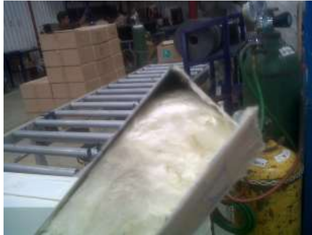
Imagen II. Espuma rígida de poliuretano en el mullion luego del proceso del espumado a 14 °C
