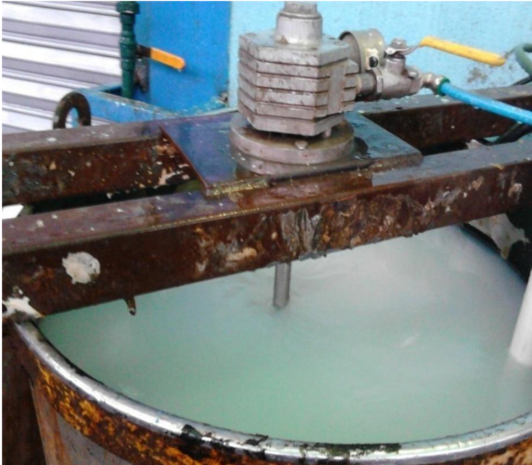
Figura 22. Tanque de coagulación-floculación con sulfato de aluminio
