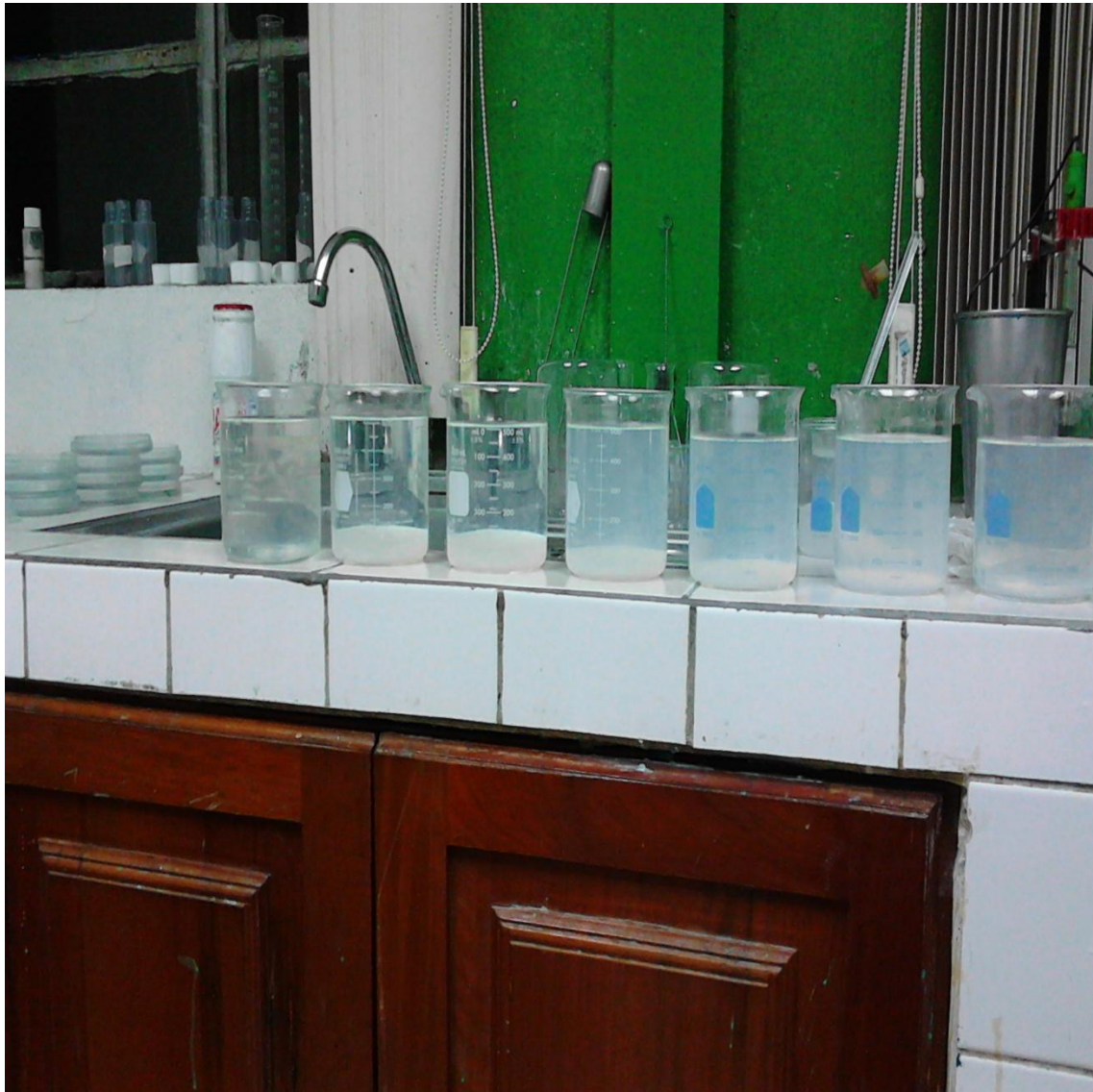
Figura 17. Dosificación con coagulante sulfato de aluminio de derecha a izquierda 50 ppm, 100 ppm, 150 ppm, 200 ppm, 250 ppm, 300 ppm y agua contaminada
