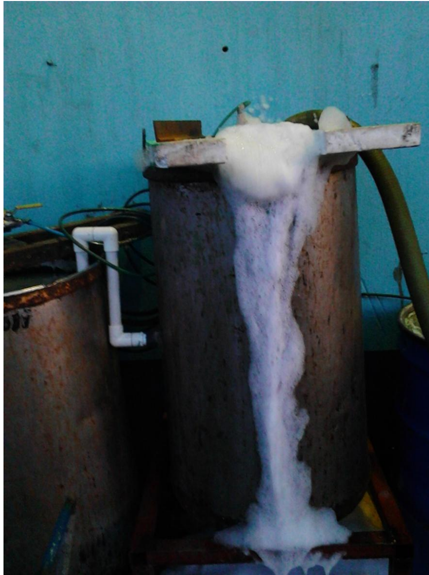
Figura 21. Tanque de aireación para la eliminación de grasas y jabones contenida en el agua contaminada
