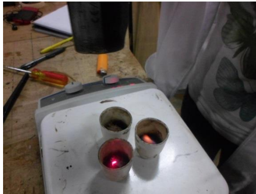
Figura 10. Determinación de la temperatura de inflamación
