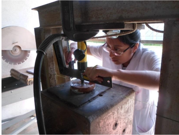
Figura 11. Determinación de la dureza de Janka
