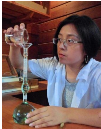
Figura 12. Determinación de la Densidad con keroseno
