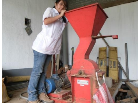
Figura 3. Molienda de materia prima. (Molino de martillos)
