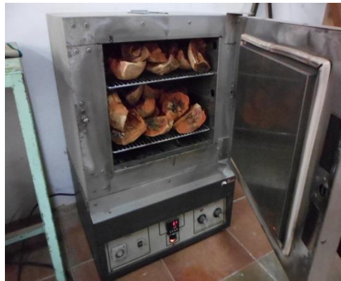
Figura 2. Secado de materia prima en horno de convección forzada
