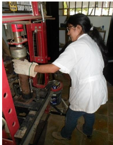
Figura 6. Compactación de las probetas ensayadas
