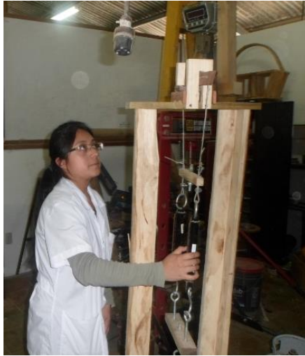
Figura 9. Prueba de capacidad máxima de flexión
