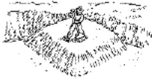
3. Inicio de la operación del relleno.
