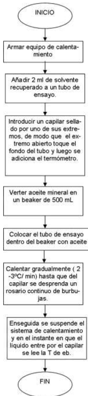
Figura 6. Diagrama para la determinación de la temperatura de ebullición los solventes recuperados
