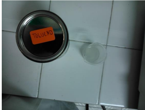
Figura 5. Prueba de afinidad con tolueno
