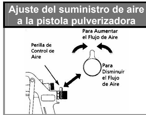
Figura 35. Ajuste del suministro de aire en la pistola pulverizadora
