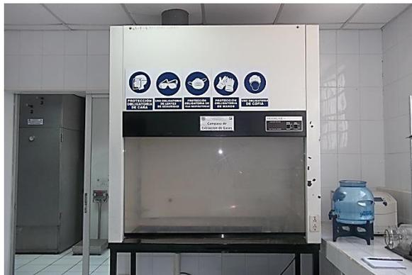
Marca: Serproma, Voltaje de 110 V y 900 Watts. Capacidad del motor  $\frac{3}{4}$  Hp
