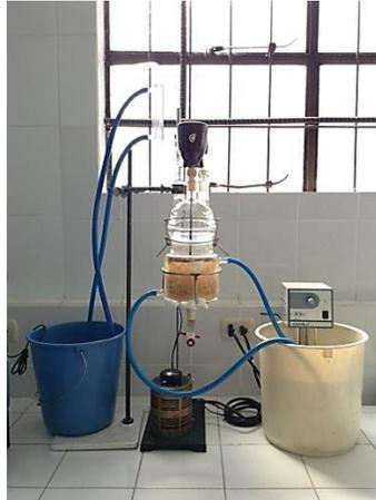
Reactor CSTR de vidrio con motor y agitador de aspas, reóstato y bomba de recirculación.
