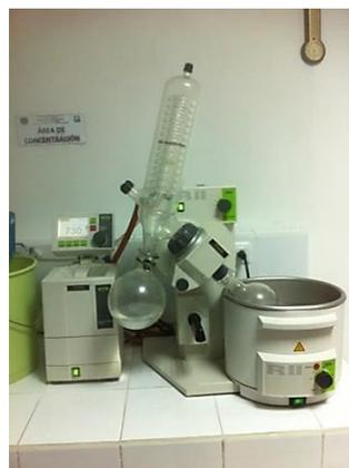
Marca: Buchi, modelo RII, rango de temperatura de 0-100 grados Celsius, rango rotación 0-12
