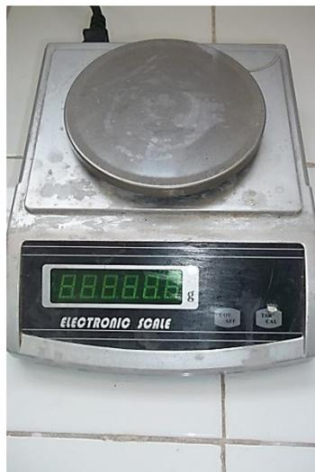
Marca: WVR, frecuencia 60 Hz, precisión hasta 0.01 g.
