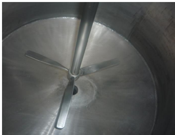
Figura 17. Marmita con agitación (parte interna)
