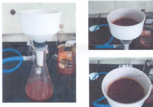
Figura No.4. Precipitación del colorante de achiote agregando ácido sulfúrico al 10% m/v y filtración al vacío.
