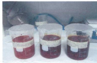
Figura No. 2. Preparación de las muestras de semilla de achiote con solvente.
