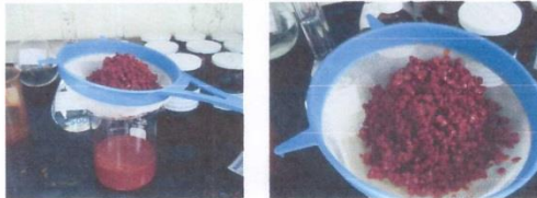
Figura No. 3. Separación del extracto colorante obtenido de las semillas de achiote.
