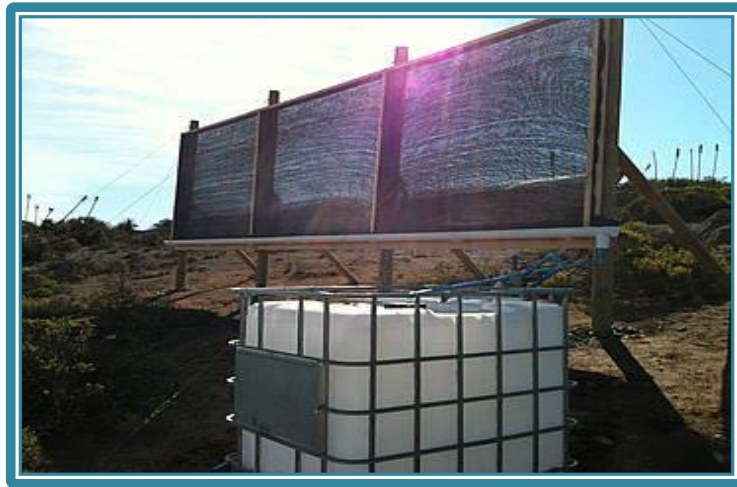
Figura 3. Atrapanieblas con su respectiva canaleta y depósito
