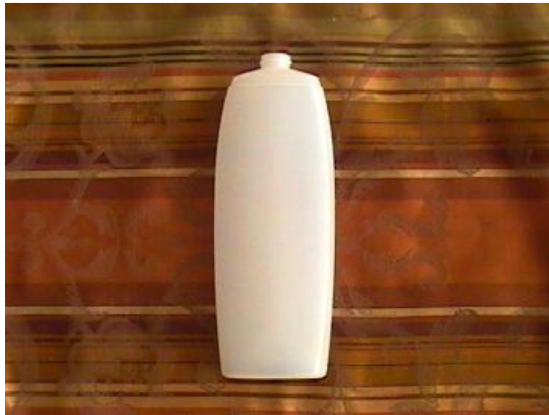
Figura 3. Envase después de haber sido eliminado el sobrante plástico
