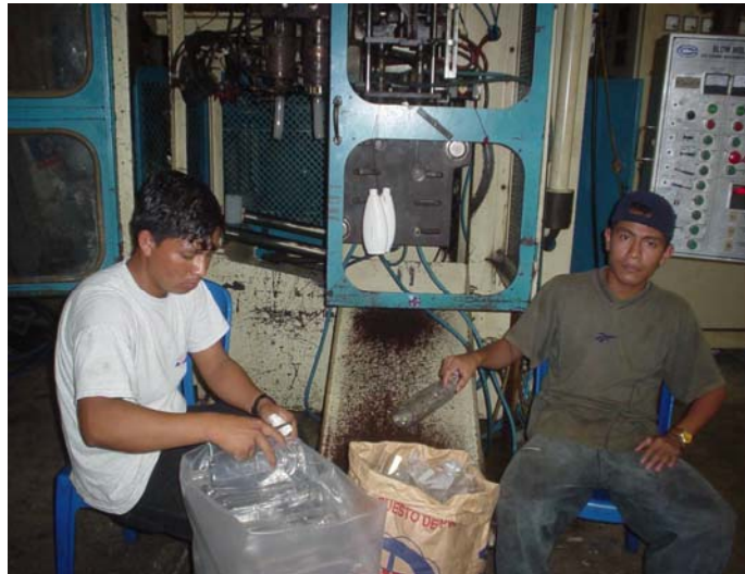
Figura 4. Máquina Sopladora Voith Fischer modelo 89 y operarios removiendo sobrante de plástico
